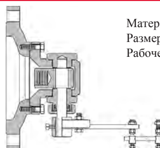
Поворотно-тяговый блок с крышкой поплавкового отверстия ТО-D
